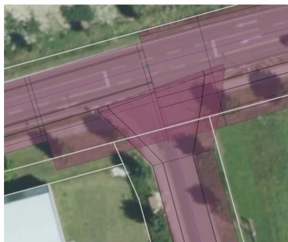
Abb. 22: Aufnahme des Anlagevermögens Straße durch Befahrung
